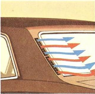
Um 360° drehbare Leitflächen an den Multi-Therm-Düsen leiten die Luft nach oben, unten, links, rechts, halblinks, halbrechts — **wie Sie es wünschen**. Eine Einrastung markiert die wirkungsvollste Entfrosterung der Seitenscheiben.
