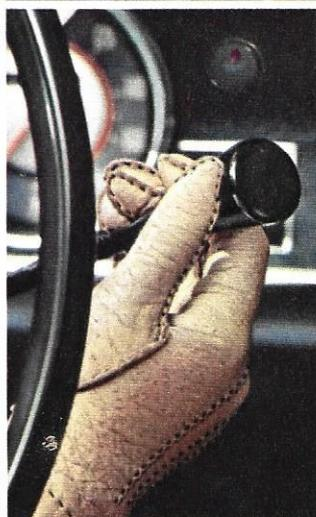
Schaltart nach Belieben! Serienmäßig Lenkradschaltung und 3-Gang-Getriebe. Gegen Mehrpreis 4-Gang-Getriebe, auch mit Mittelschaltung (im Coupé serienmäßig). Oder in Verbindung mit 1.9 Ltr.-S-4 Zyl.- und 2.2 Ltr.-6 Zyl.-Motor eine AUTOMATIC für unbegrenzten Schalturlaub. Eine Wohltat!
