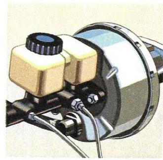
Das Zweikreis-Bremssystem gibt Ihnen doppelte Sicherheit. Die Bremssysteme der Vorder- und Hinterräder sind getrennt. Der Bremskraftverstärker bewirkt hohe Bremsleistung bei geringem Pedaldruck.
